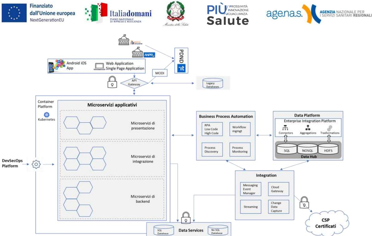
Figura 8 - Esempio di modello fisico di riferimento
