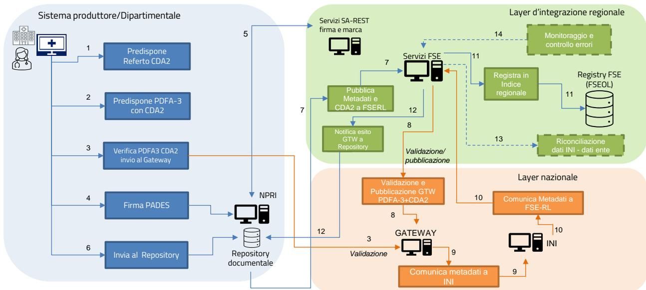
Figura 1: Integrazione con i servizi del Gateway FHIR
