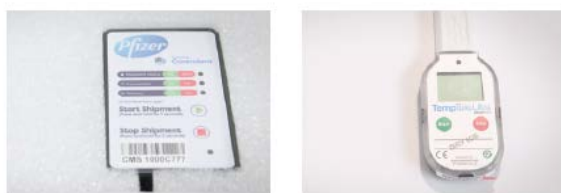
Figura 5: dispositivi per il monitoraggio della temperatura. Controlant Real-Time Monitor a sinistra, Sensitech Temperature Monitor a destra
